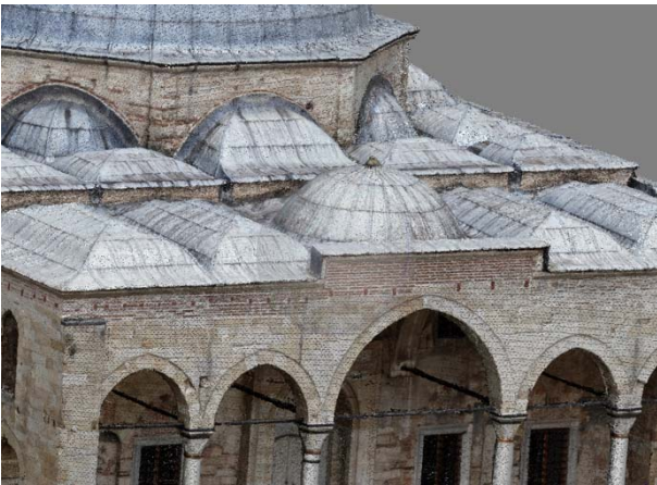
Εικόνα 5 – Το πυκνό νέφος σημείων του μνημείου.
