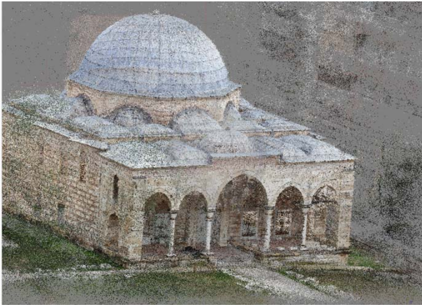
Εικόνα 4 – Το αραιό νέφος σημείων του μνημείου.
