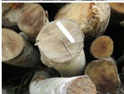
Εικόνα 1: Σήμανση υλοτομηθείσας ξυλείας με RFID tag.
